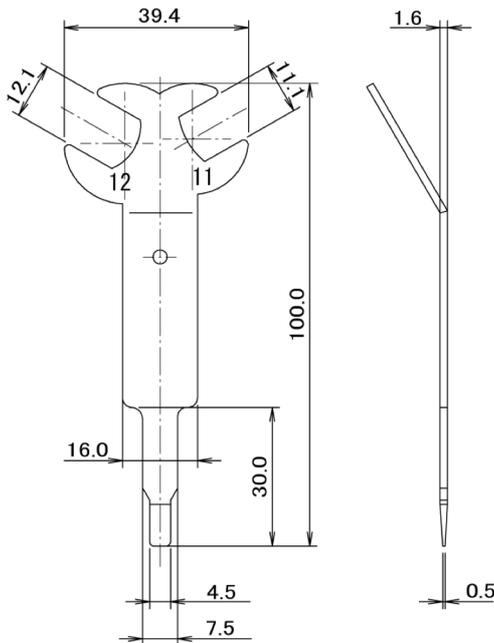
材質： 圧延鋼板
